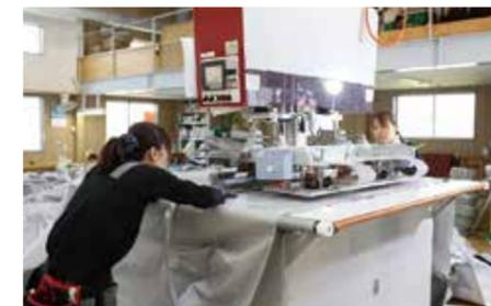
大型のウェルダーによりテント生地を溶着（溶かして接着）し、規定の寸法に仕上げていきます。
