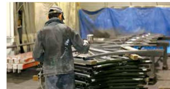
塗装工場では、溶接し終わった鉄鋼部材に吹付け塗装をします。
