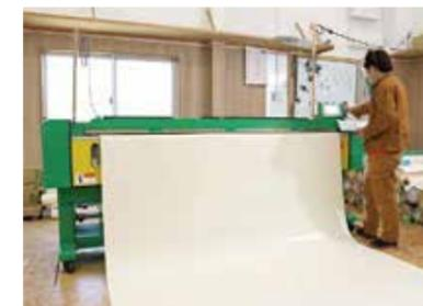
専用の大型裁断機によりテント生地を規定寸法に合わせて裁断しています。
