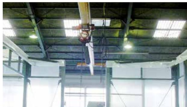
天井カーテンと側面扉により走行クレーンでの作業が可能
